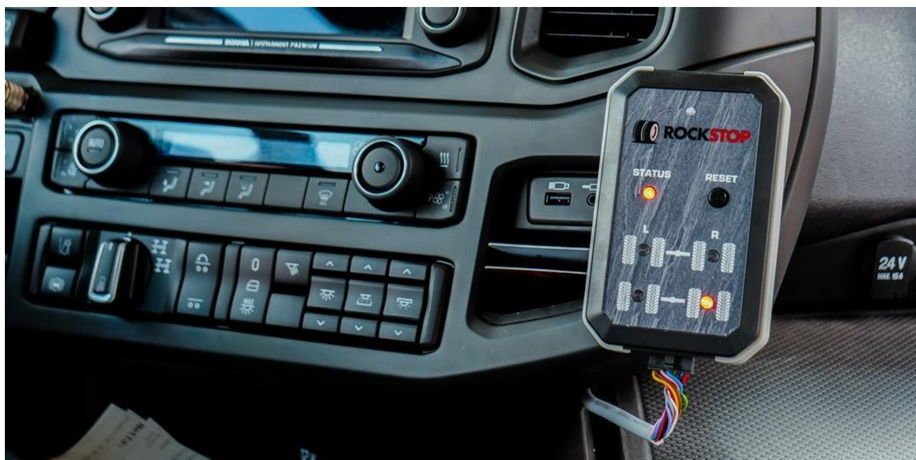
Systemet viser stein i tvillinghjul bak på høyre side
