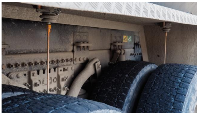
Sensorer monteres mellom tvillinghjulene
