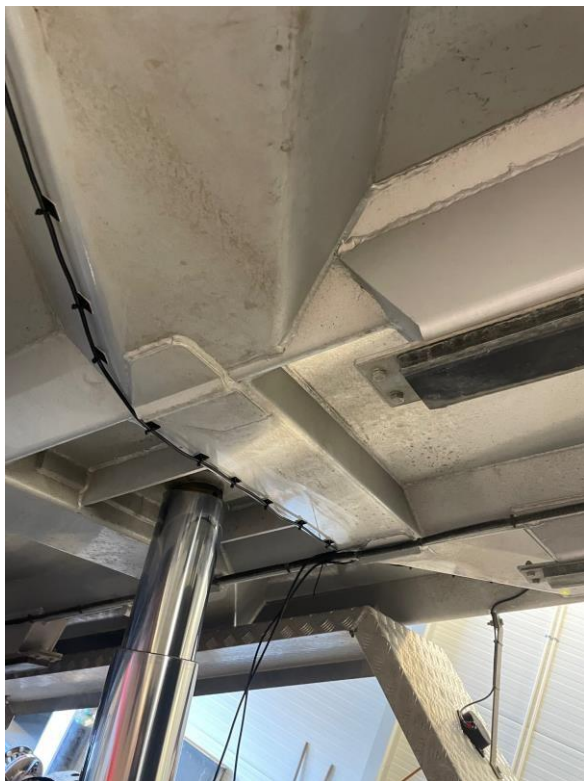
Kablene stripses fast til kassa for biler med stålskjermer
