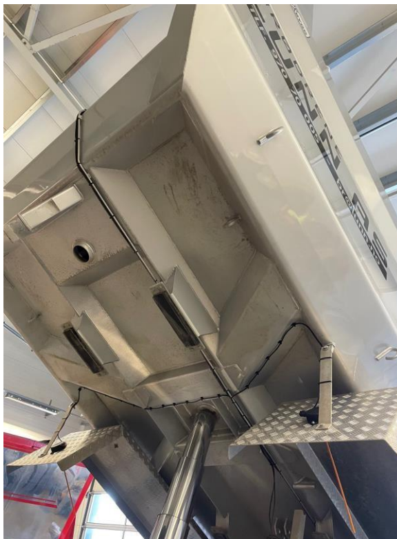
Kablene stripses fast til kassa for biler med stålskjermer
