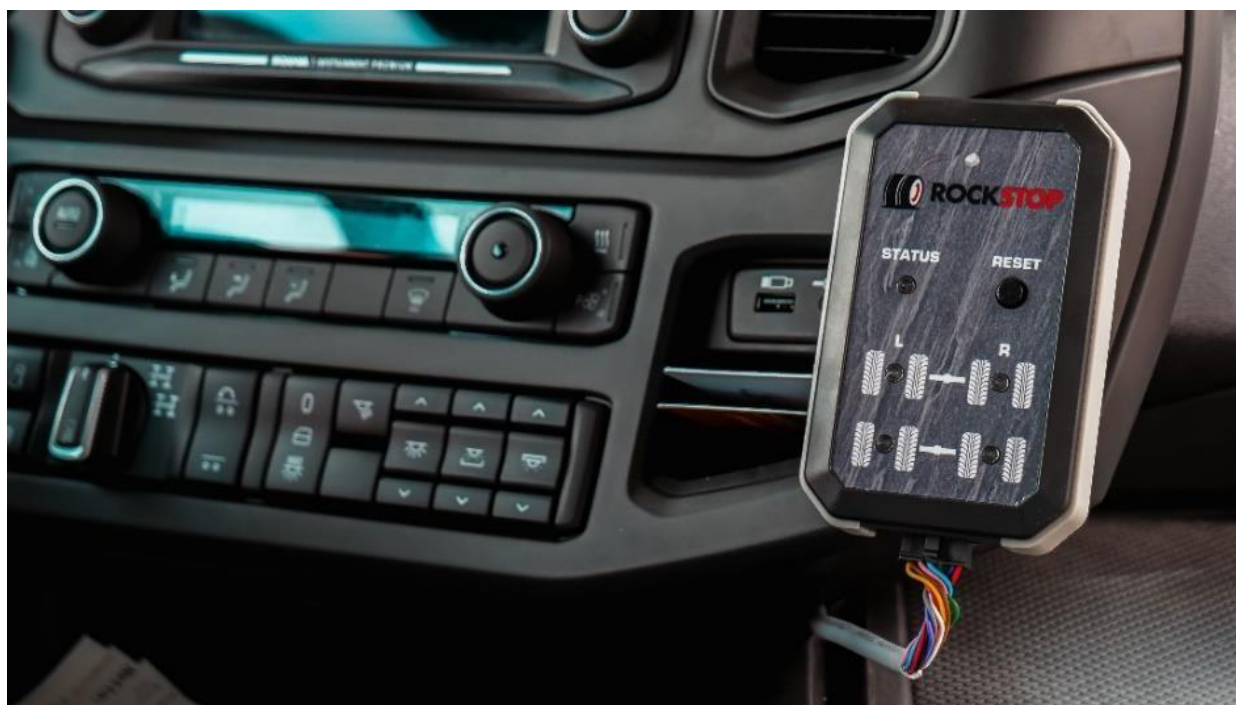
Displayet monteres i nærheten av sjåføren i førerhytten
